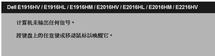
如果未连接VGA线，会显示如下所示的浮动对话框。显示器在此状态停留**5分钟后进入节能模式**。
