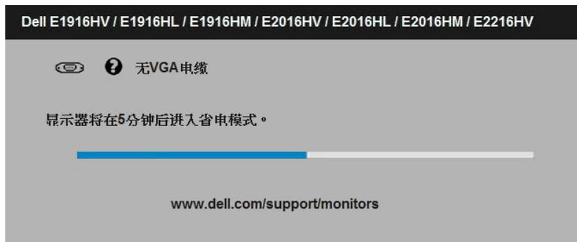
4. 在正常系统操作期间，如果视频线断开连接或已损坏，也会出现这个对话框。显示器在此状态停留**5分钟后进入节能模式**。
